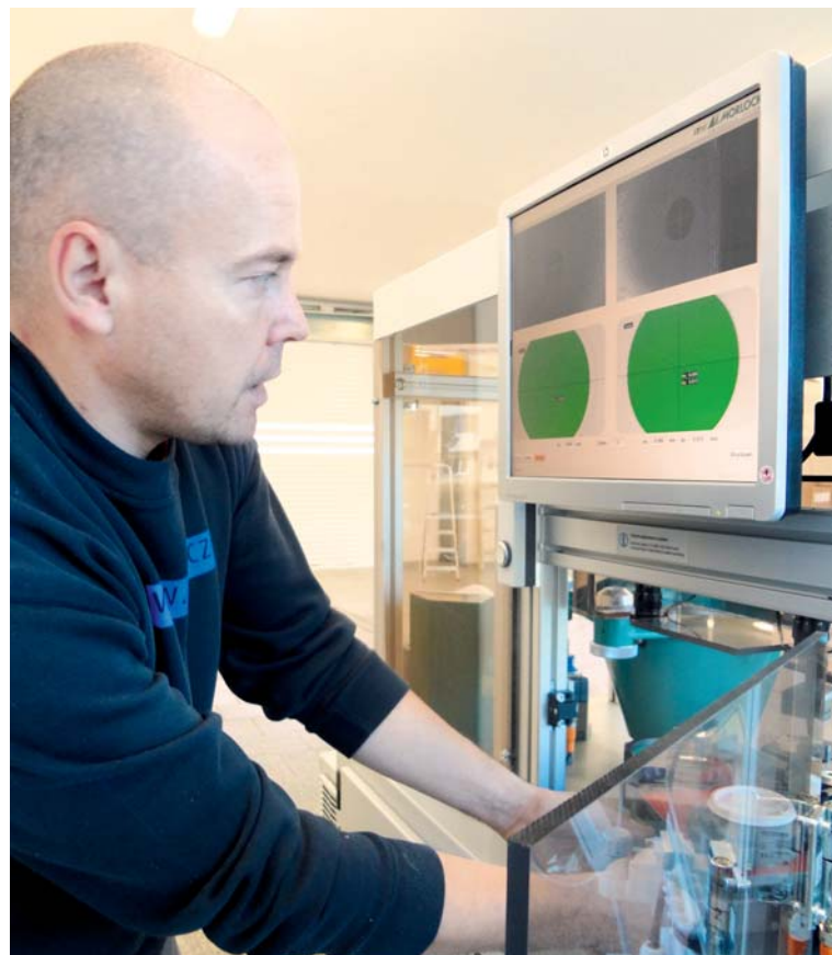
■ Milan Vacek na novém tampo tisku nastavuje soutisk barev pomocí kamer.
